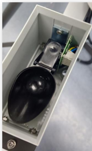
รูปที่ ๘ ด้านในของเครื่องวัดปริมาณน้ำฝน
