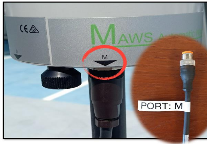
รูปที่ ๔๘ เชื่อมต่อสายสัญญาณกับชุดอุปกรณ์ประมวลผล
