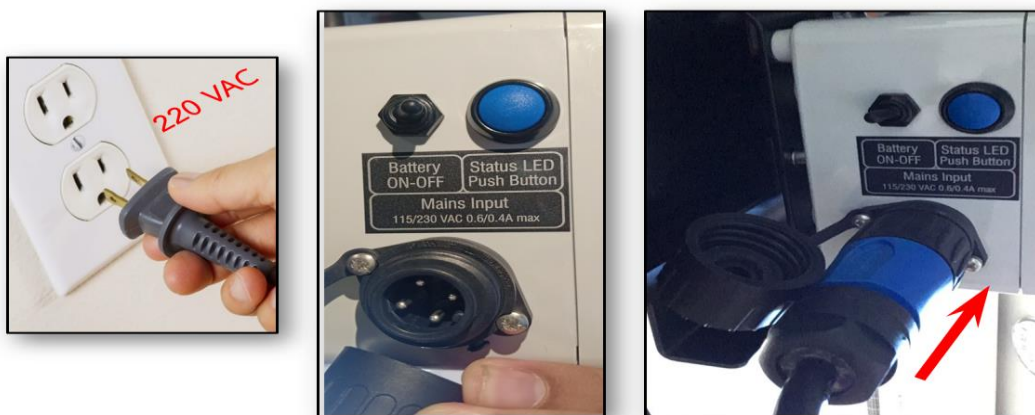
รูปที่ ๘๘ การเชื่อมต่อกับแหล่งจ่ายกระแสไฟฟ้า (220 VAC)
