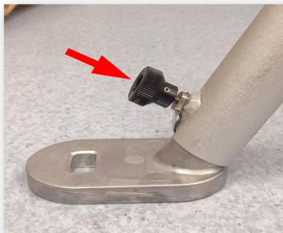
รูปที่ ๒๘ สกรูล็อคขาตั้ง (สำหรับปรับด้วยมือ)
