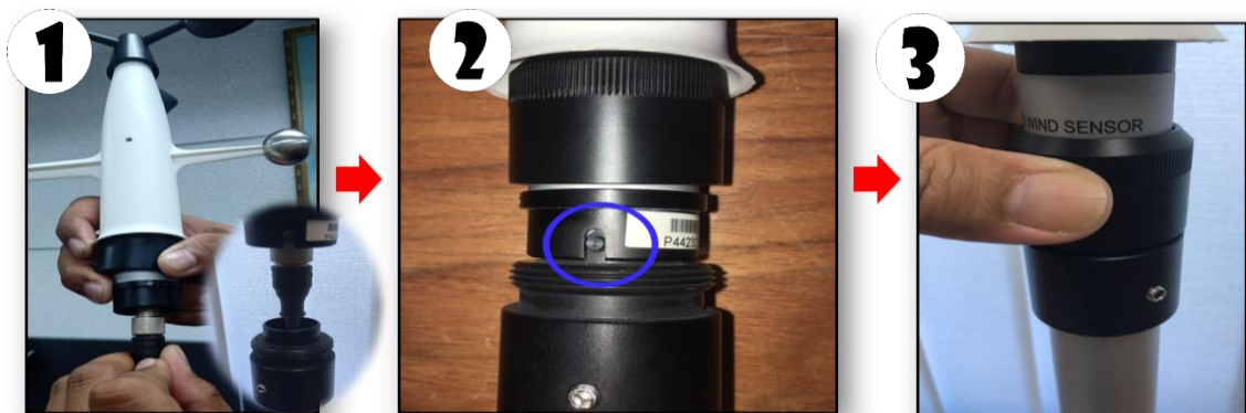
รูปที่ ๔๑ การประกอบเครื่องวัดทิศทางและความเร็วลมเข้ากับเสาเครื่องวัด
