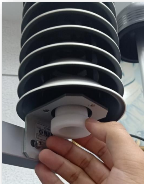
รูปที่ ๓๕ ตัวล็อคเครื่องวัดที่ติดอยู่กับอุปกรณ์ป้องกันรังสีจากดวงอาทิตย์
