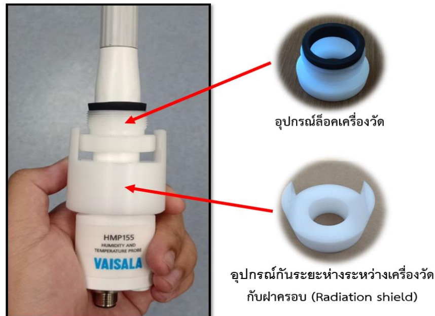
รูปที่ ๓๖ อุปกรณ์ล๊อคเครื่องวัด และอุปกรณ์กันระยะห่างฯ ที่สวมเข้าไปที่เครื่องวัดอุณหภูมิและความชื้นสัมพัทธ์
