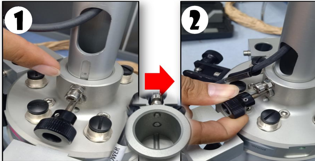
รูปที่ ๔๒ การประกอบเสาเครื่องวัดเข้ากับชุดขาตั้ง
