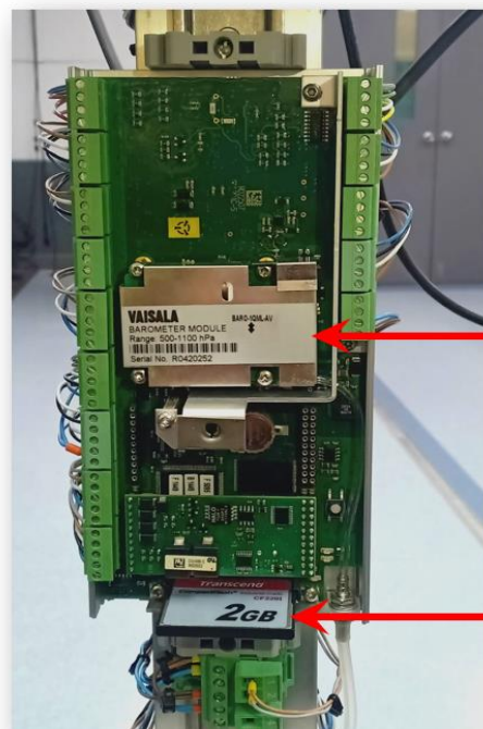
รูปที่ ๑๒ อุปกรณ์บันทึกข้อมูล (CF card) และเครื่องวัดความกดอากาศ (BARO-1)
