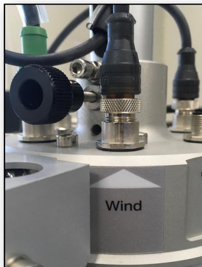
รูปที่ ๔๓ การต่อสายสัญญาณเครื่องวัดทิศทางและความเร็วลม เข้ากับชุดอุปกรณ์ประมวลผล
