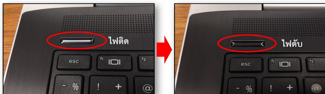
รูปที่ ๙๑ ไฟสถานะปิด-เปิด เครื่องคอมพิวเตอร์
