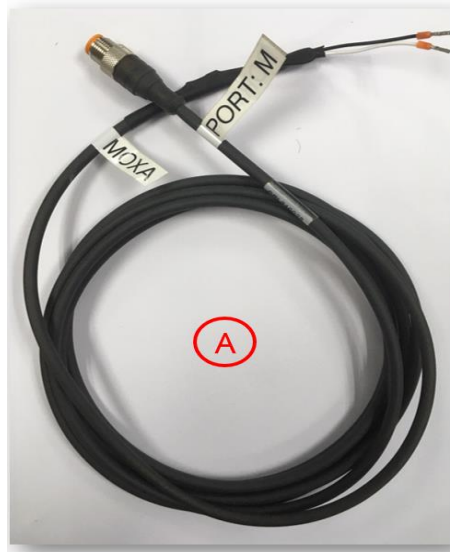
รูปที่ ๒๒ สายสัญญาณ (2 Wire RS-485) ความยาว ๓ เมตร
