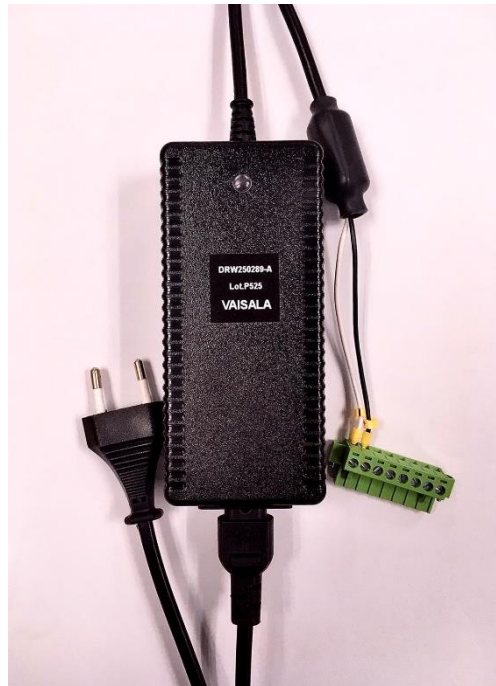
รูปที่ ๑๘ หม้อแปลงไฟฟ้าสำหรับ MOXA
